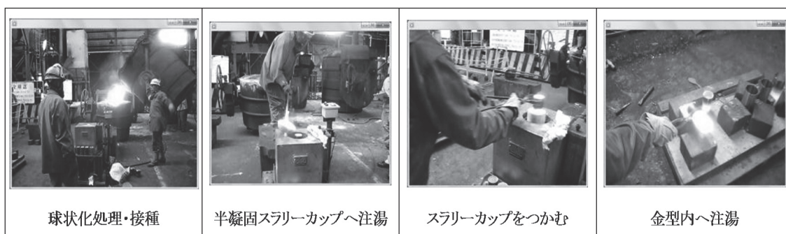
図13 フリー窒素・ナノキャスト法による半凝固鑄造
